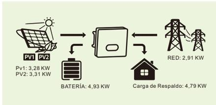
Ejemplo 3: PV > Carga + Batería, PV proporciona energía a la Batería primero, y luego a la Carga, y la energía restante se alimentará a la Red.
