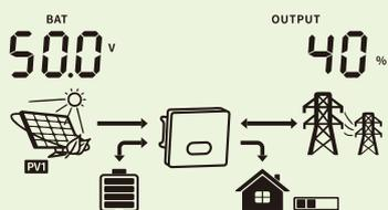
**Tension batterie/charge de secours VA**
