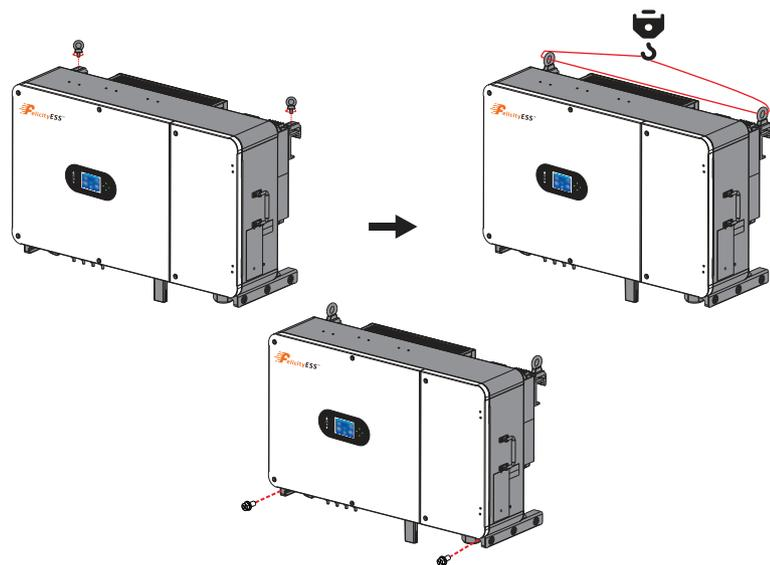
Abbildung 3.4-2 Installieren eines Wechselrichters
