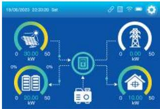
Beispiel 2: Bei  $P_{pv} < P_{load}$  und  $P_{pv} + P_{batMaxDischarge} > P_{load}$ , versorgen der PV und der Akku die Last gemeinsam mit Strom.
