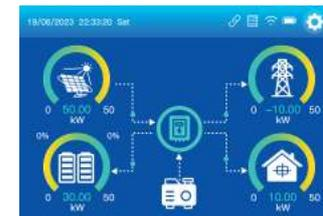
Beispiel 2: Bei  $P_{load} + P_{batmaxcharge} > P_{pv} > P_{load}$ , wird die PV-Anlage die Last mit Strom versorgen, und der von der PV-Anlage erzeugte Überschussstrom wird den Akku aufladen. der Akku wird nicht über das Stromnetz aufgeladen.
