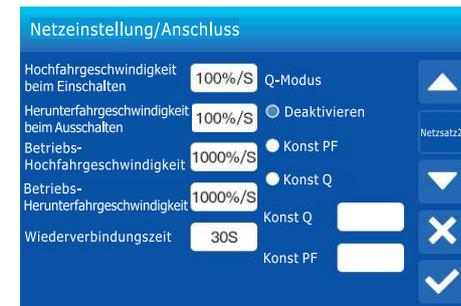
**Hochfahrgeschwindigkeit:** Es handelt sich um die Start- und Wiederverbindungsleistungsgeschwindigkeit. Zum Beispiel bedeutet eine Hochfahrgeschwindigkeit beim Einschalten von 100%/s, dass die Ausgangsleistung innerhalb von 1 Sekunde von 0 kW auf 100% der Nennleistung ansteigt.
