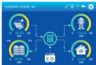
Beispiel 2: Bei  $P_{load} + P_{batmaxcharge} > P_{pv} > P_{batmaxcharge}$ , lädt der PV den Akku auf, die überschüssige Energie, die vom PV erzeugt wird, wird zusammen mit dem Stromnetz an die Last geliefert
