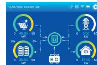
Beispiel 3:  $P_{pv} < P_{batmaxcharge}$ , Netz lädt den Akku und versorgt die Last.
