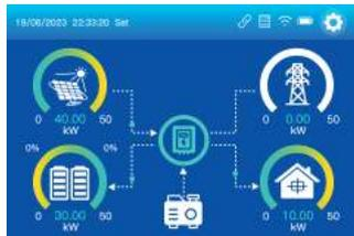
Beispiel 2:  $P_{load} + P_{batmaxcharge} > P_{pv} > P_{load}$ , wird die PV die Last mit Strom versorgen, und der von der PV erzeugte Überschussstrom wird den Akku laden. Der Akku wird nicht über das Stromnetz aufgeladen
