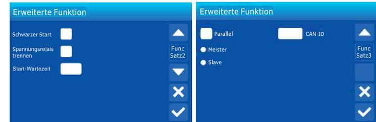
**Parallel:** Wenn der Benutzer die Systemkapazität durch Parallelbetrieb erweitern möchte, muss er auf die Schaltfläche Parallel klicken. Und in einem Parallelbetriebssystem kann es nur einen Master geben, und die anderen müssen als Slave eingestellt werden. Außerdem muss jedem Wechselrichter eine eindeutige CAN-ID zugewiesen werden, die von 1 bis 10 reicht.
