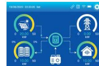
Beispiel 3: Bei  $P_{pv} < P_{load}$  und  $P_{pv} + P_{batmaxdischarge} > P_{load}$ , werden die PV und der Akku die Last gemeinsam versorgen.
