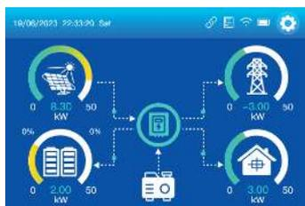
1. Das Symbol in der Mitte der Startanzeige zeigt an, dass sich das System im Normalbetrieb befindet. Wenn es sich in „comm./F01~F100“ verwandelt, bedeutet dies, dass der Wechselrichter Kommunikationsfehler oder andere Fehler aufweist; die Fehlermeldung wird unter diesem Symbol angezeigt (F01-F100-Fehler, detaillierte Fehlerinformationen können im Systemalarm-Menü angezeigt werden).
