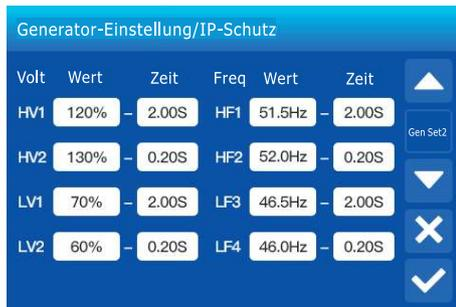
**HV1:** Überspannungsschutzpunkt und Schutzzeit der Stufe 1;
