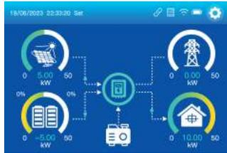
Beispiel 4: Bei  $P_{pv} + P_{batmaxdischarge} < P_{load}$ , werden die PV und der Akku die Last gemeinsam versorgen. Das Netz wird auch die Last mit Strom versorgen.
