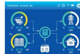
Beispiel 2:  $P_{pv} > P_{batmaxcharge}$ , und  $P_{pv} < P_{batmaxcharge} + P_{load}$ , PV lädt den Akku und versorgt die Last, Das Netz versorgt die Last.
